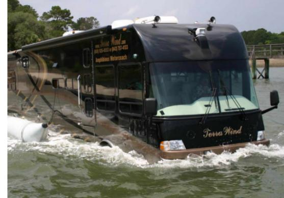
**Flossen hoch!** Das Luxus-Wohnmobil „Terra Wind“ kann sogar Flüsse und Seen durchqueren. Berührt das Reisemobil Wasser, wird es automatisch von seitlichen Flossen gehalten und von zwei Bronze-Propellern angetrieben.
